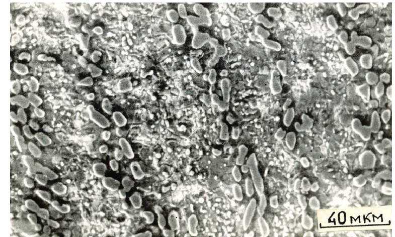
სურ. 23. ბულატის ფოლადისათვის დამახასიათებელი რკინის მეორადი კარბიდების კოლონიები
